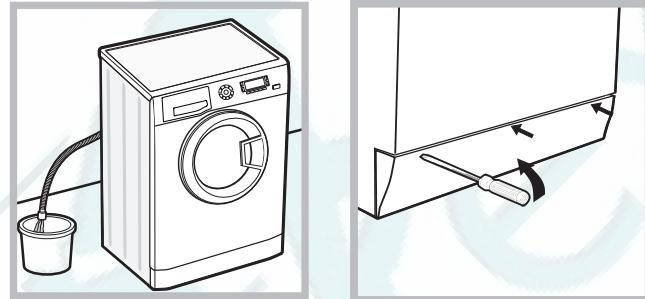
2. проверьте, чтобы уровень воды в машине был ниже отверстия люка. В противном случае слейте излишек воды через сливную трубу в ведро, как показано на схеме.
